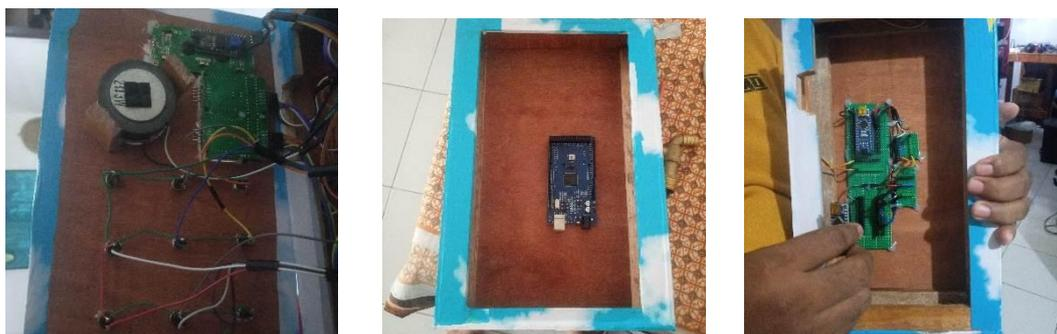
Gambar 5. Pemasangan Arduino dan kabel pada tombol angka 0-9
